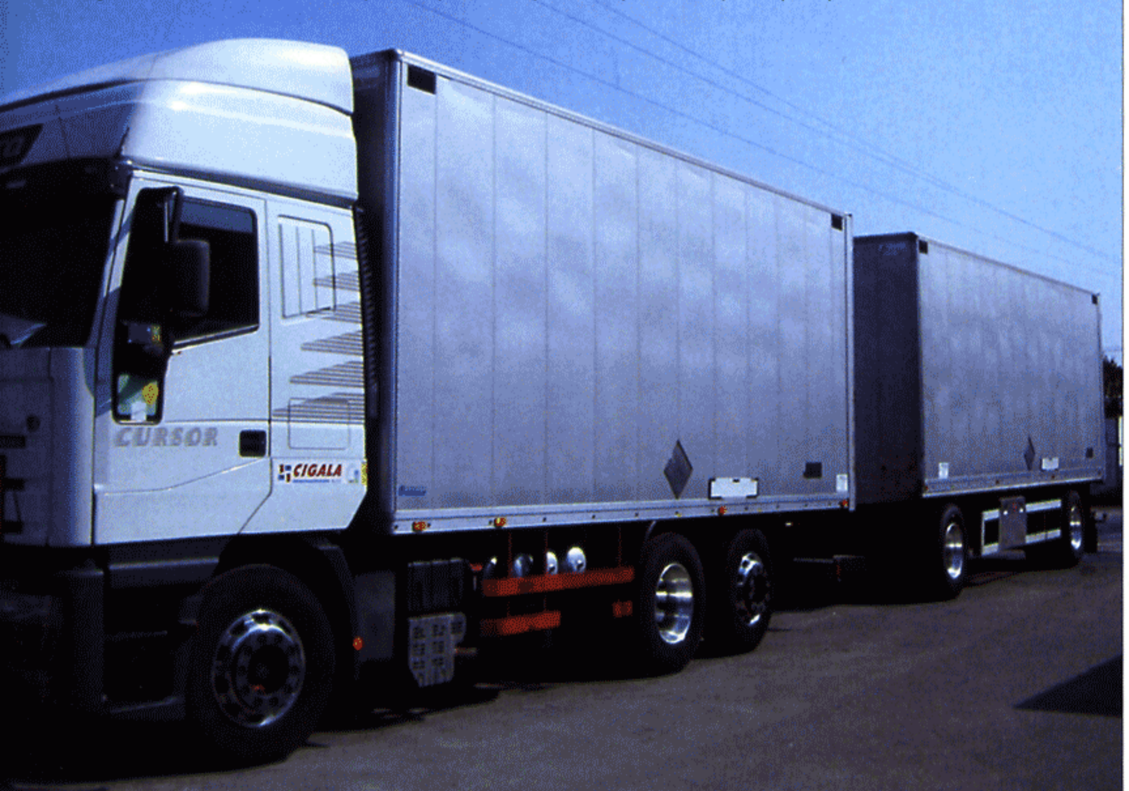
Vehículo de Cigala Internazionale SRL destinado al transporte de explosivos, en cuyo interior dispone de una caja fuerte para separar dicho material de los detonadores.
